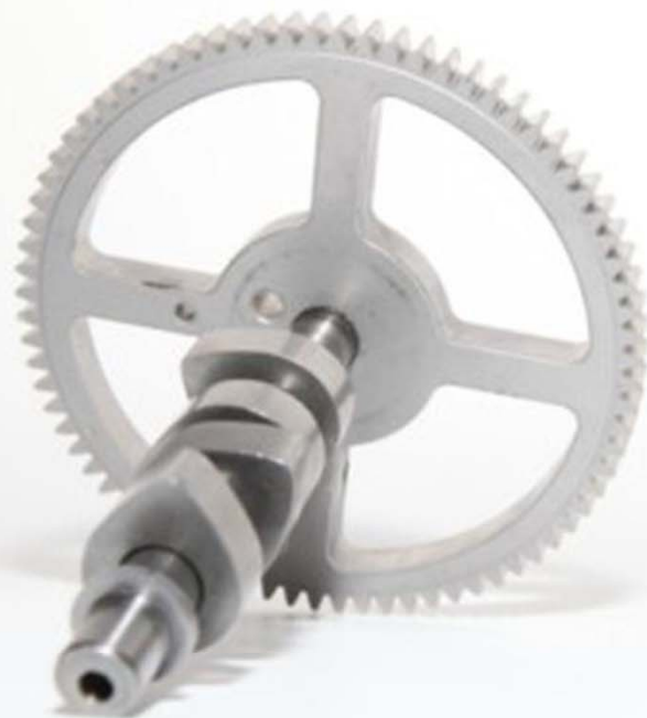
INTEK K dekompresi slouží nepatrná změna profilu sací vačky
