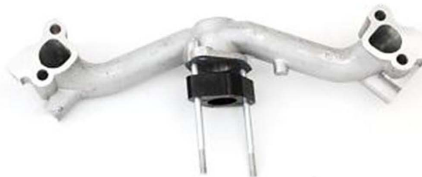
VANGUARD Hliníkové sací potrubí s mezikusem
